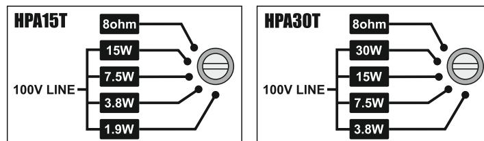
При выборе мощности в 100V трансформаторном режиме необходимо иметь в виду, что суммарная мощность всех громкоговорителей не должна превышать заявленную мощность трансляционного усилителя (наиболее корректно будет, если мощность громкоговорителей будет меньше на 10% мощности усилителя). Низкоомное (4-16ohm) и 100V оборудование несовместимы. Четко соблюдайте это при установке селектора на корпусе рупора.
